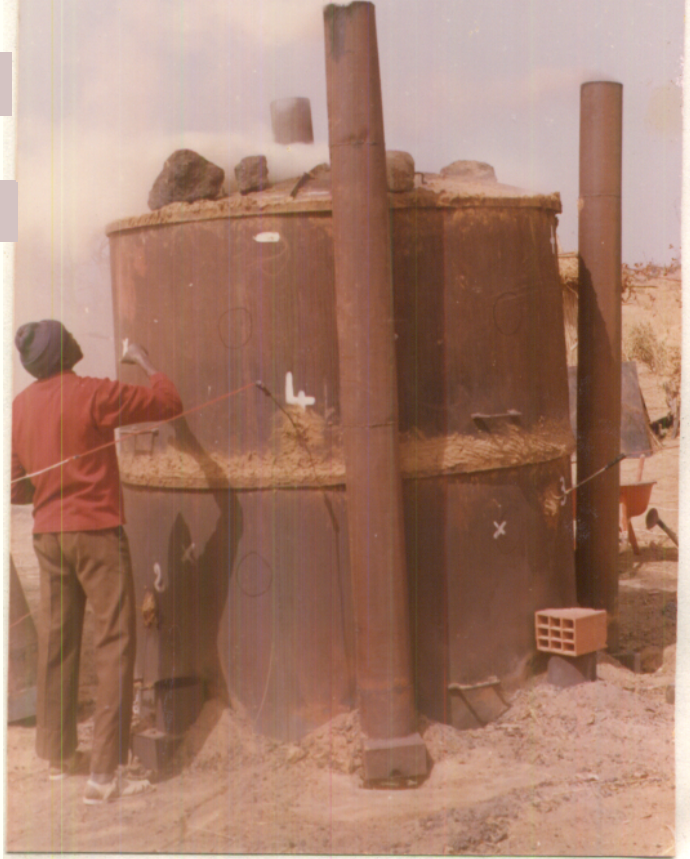
PHOTO 1 Début de la phase de tirage inversé. Les troischeminées sont déjà en place et les événements situés du côté du vent fermés pour diminuer l'entrée de l'air.
