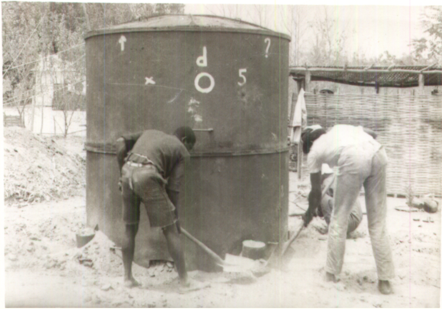
PHOTO 3 : Défournement - Dégagement des événements et des supports de cheminées.
