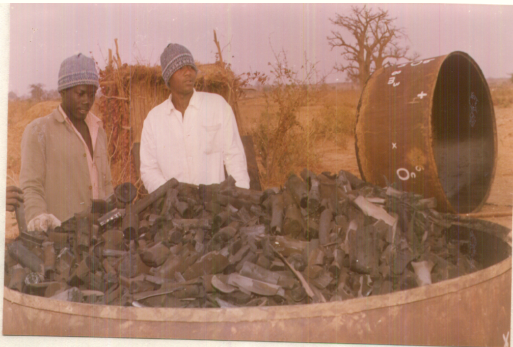
PHOTO 4 : Défournement - Dégagement de la section supérieure
