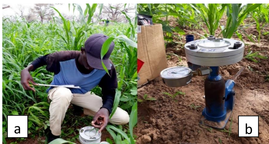
Figure 12 : Mesure du potentiel hydrique foliaire (a) à l'aide d'une chambre à pression (b)
