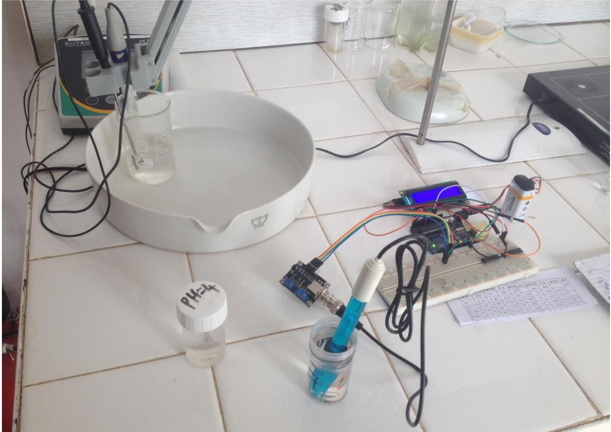
Capture 4. 10 : Calibrage du capteur de pH, Laboratoire Eau-Sol-Plante du CNRA de Bambey
