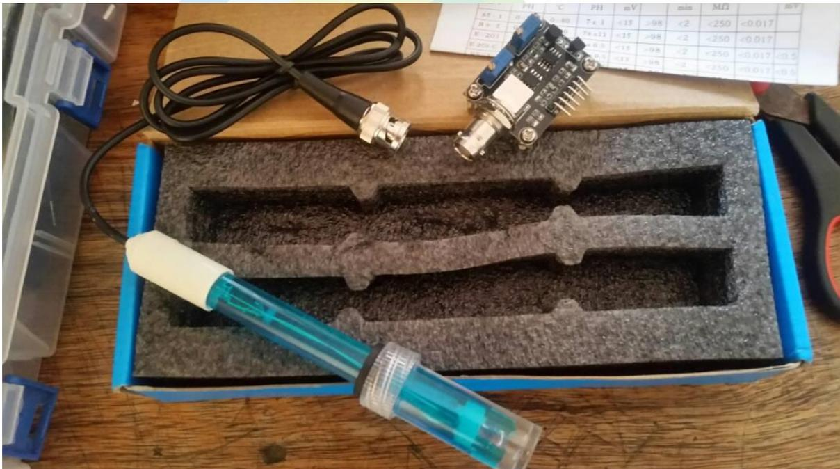
Capture 4.5 : Capteur de pH avec Logo\_PHsensor compatible arduino
