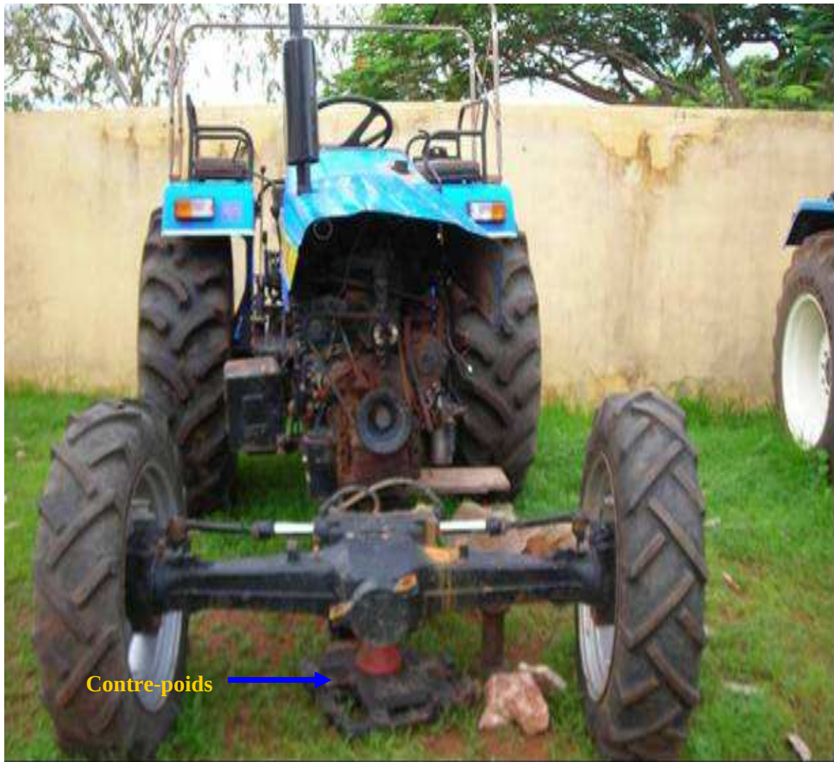
Figure 7: cassure des supports de masses d'alourdissement et des boulons qui les soutiennent chez un tracteur à 4 roues motrices.
