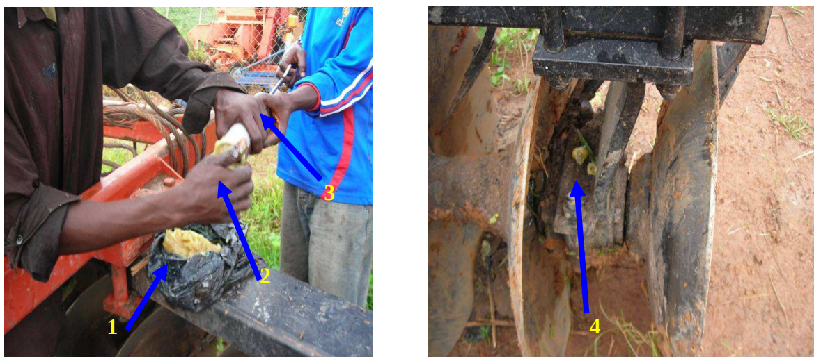
Figure 8 : Séance de graissage des roulements des disques d'un offset
