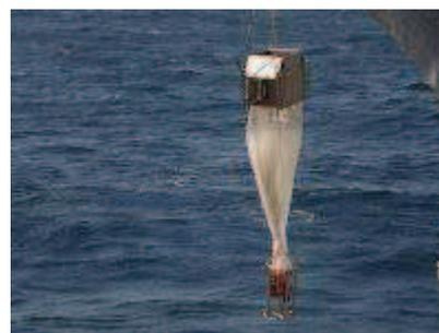
Figure 3: Filet "multinet" avec un débitmètre électronique fixé à l'extrémité. Photo de *Cruise Nansen - Madagascar 2009*.
