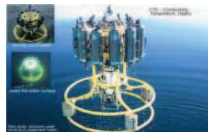
Figure 2: Une multisonde CTD avec des bouteilles Niskin disposées en rosette.
