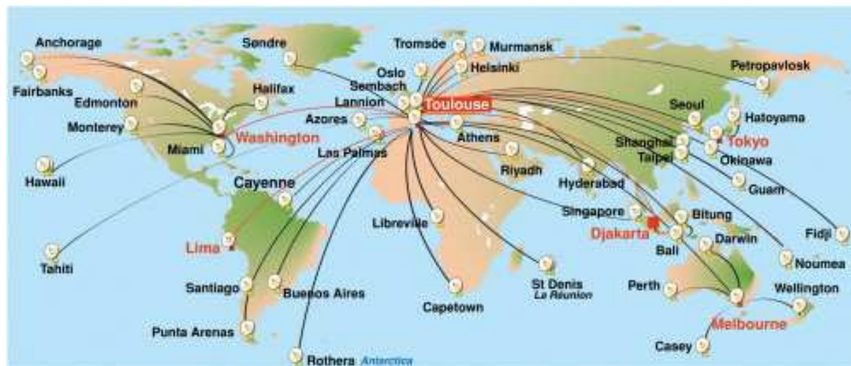
Figure 3.4 : Stations formant le temps réel en bande L antenne-réseau. Chaque station reçoit des données en temps réel à partir des satellites et les retransmet vers des centres de traitement.
