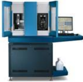
Appareil pour Microséquençage par le système SOLID (Seq. by Oligo Ligation/Detection),
